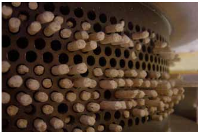
Der Rohstoff wird durch eine Matrize gepresst.
