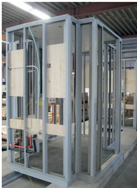
Leichtbau-Fertigbad in der Produktion: Verrohrung Kaltwasser, Warmwasser, Elektro, Lüftung.
